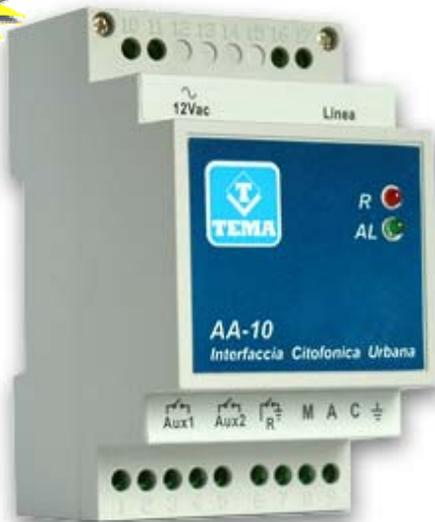
L'interfaccia citofonica AA-10 consente di interfacciare qualunque citofono (a 4 o 5 fili) ad un ingresso di linea urbana del centralino (PBX) allo scopo di gestire il posto citofonico da un qualsiasi interno dell'impianto telefonico.
